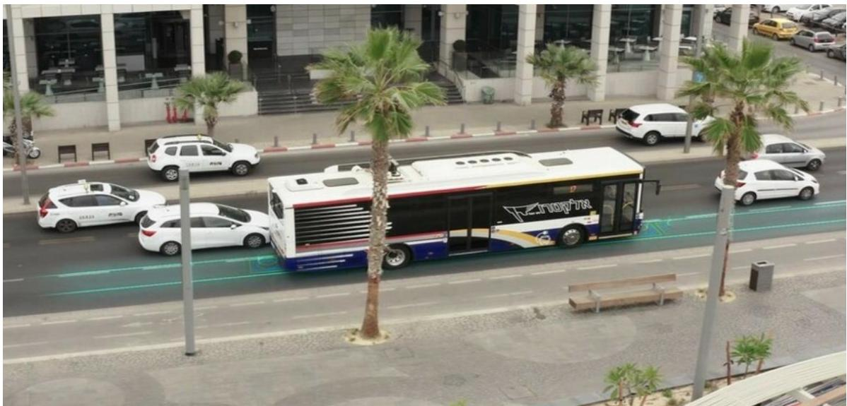
図表 38：スエーデンに於ける走行中ワイヤレス給電の実証試験（出典：ElectReon）
